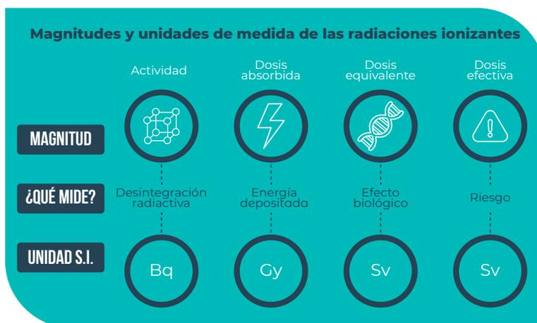
**Figura 12.** Magnitudes y unidades de medida de las radiaciones ionizantes (Fuente: adaptado de Foro Nuclear, 2018).
